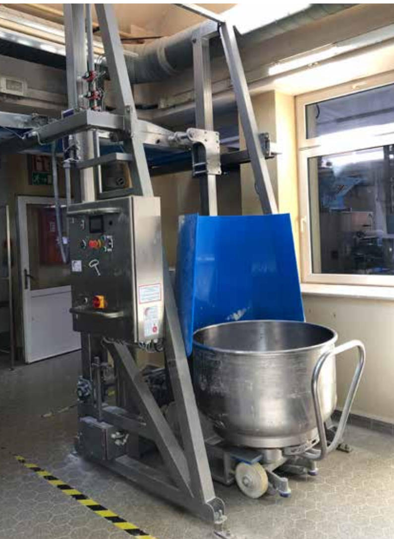
Die Kopfmachine Classic Rex (Foto oben) wird über eine Hebe-Kipp-Anlage (Foto unten) beschickt, die sich im Bestandsbau befindet
