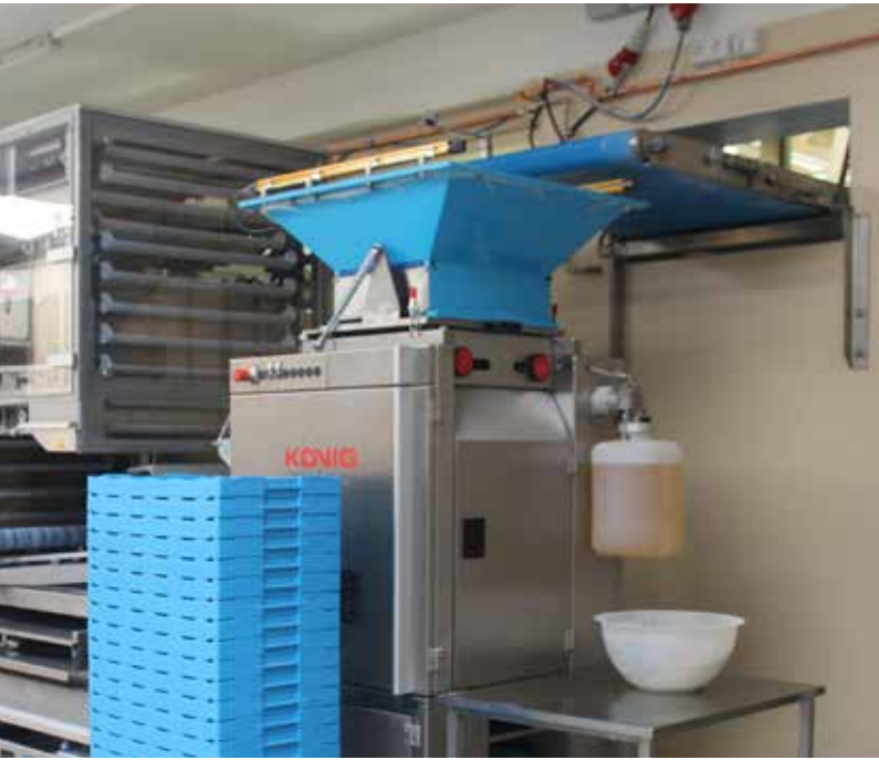
Die Kopfmachine Classic Rex (Foto oben) wird über eine Hebe-Kipp-Anlage (Foto unten) beschickt, die sich im Bestandsbau befindet
