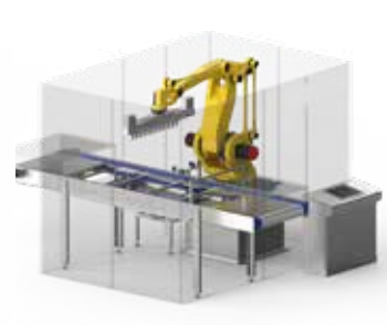
Arm-Roboter-Version mit 12 Köpfen für 12 gleichzeitige Schnitte
